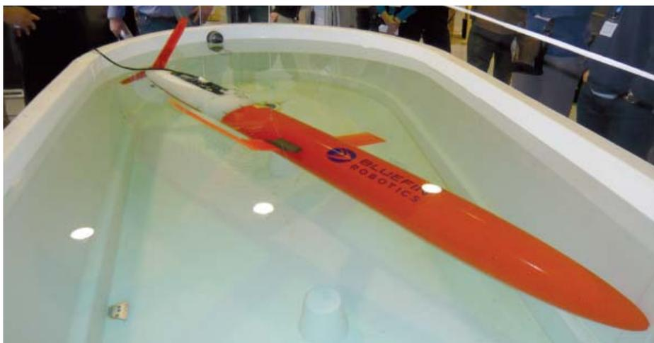
**Calibración en laboratorio (Ballasting)**
